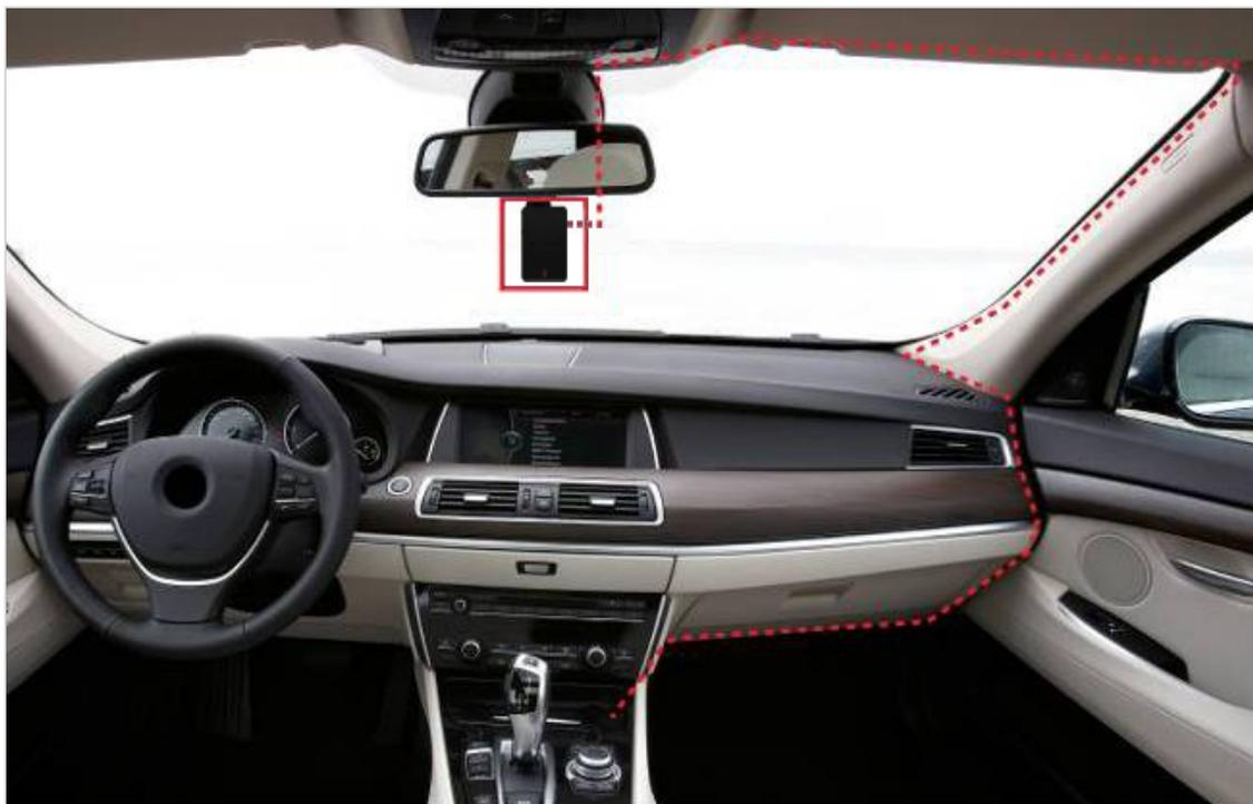
8. 啟動車子引擎後，DrivePro行車記錄器即自動開機錄影。您可於行動裝置下載DrivePro App進行後續設定，並確認行車記錄器所拍攝的視野範圍。
