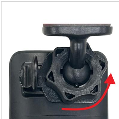
5. 當位置調整好，將環扣以順時針方向轉緊至最底部，以確保DrivePro行車記錄器已完全固定。
